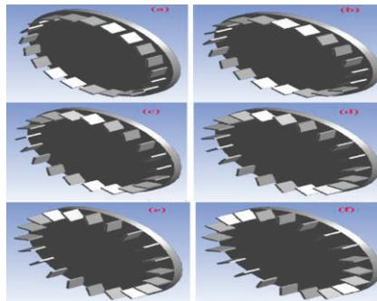
Figure 8: Model (A) 25 fins at different fins tilt angles, (a) 15°, (b) 30°, (c) 45°, (d) 60°, (e) 75°, (f) 90°
